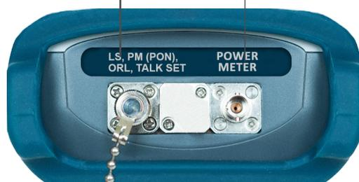
Разъем измерителя мощности
